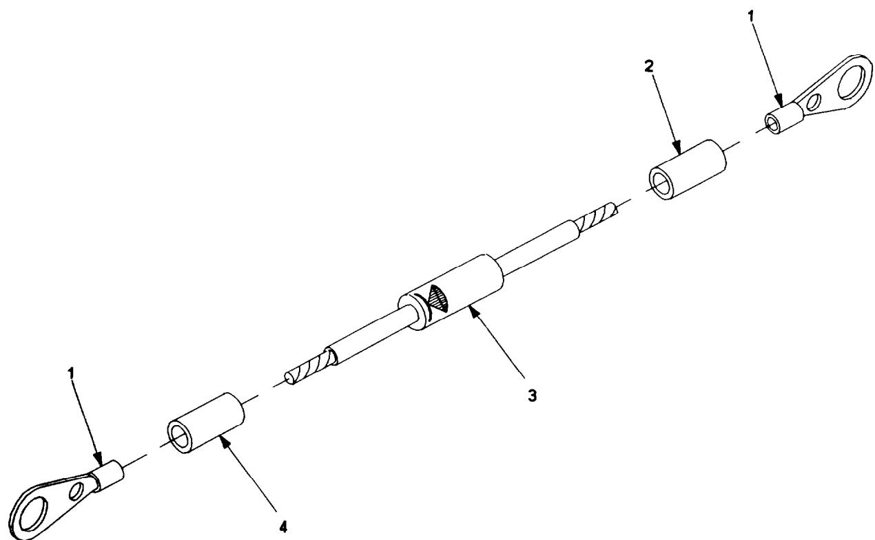
Figure 23. Jumper Diode 9353927-2.
