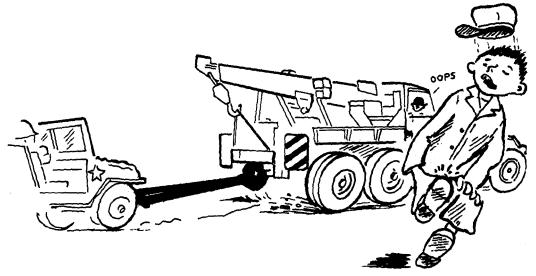
THE TOWBAR IS ALWAYS ATTACHED TO TOW TRUCK LAST!!
