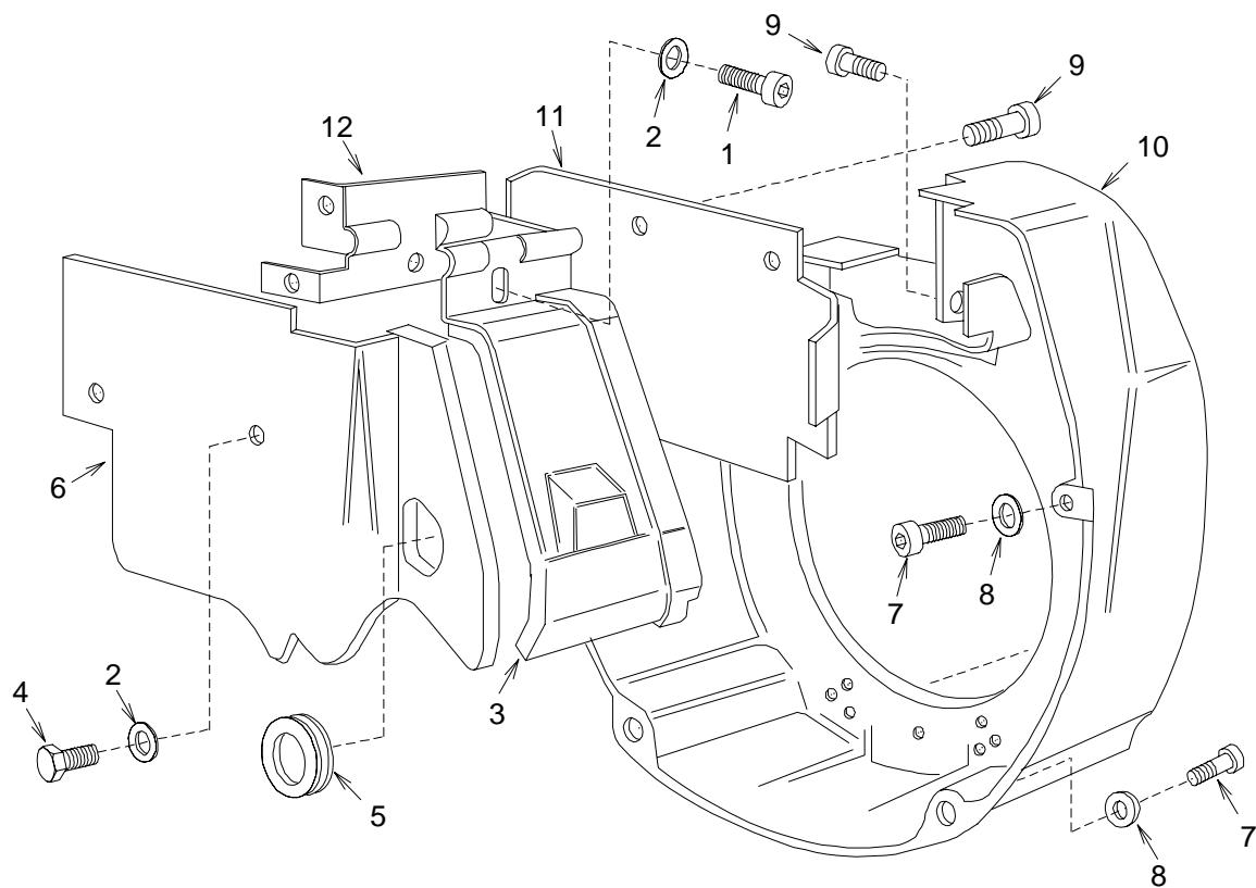
**Figure 15. Cooling Shroud**
