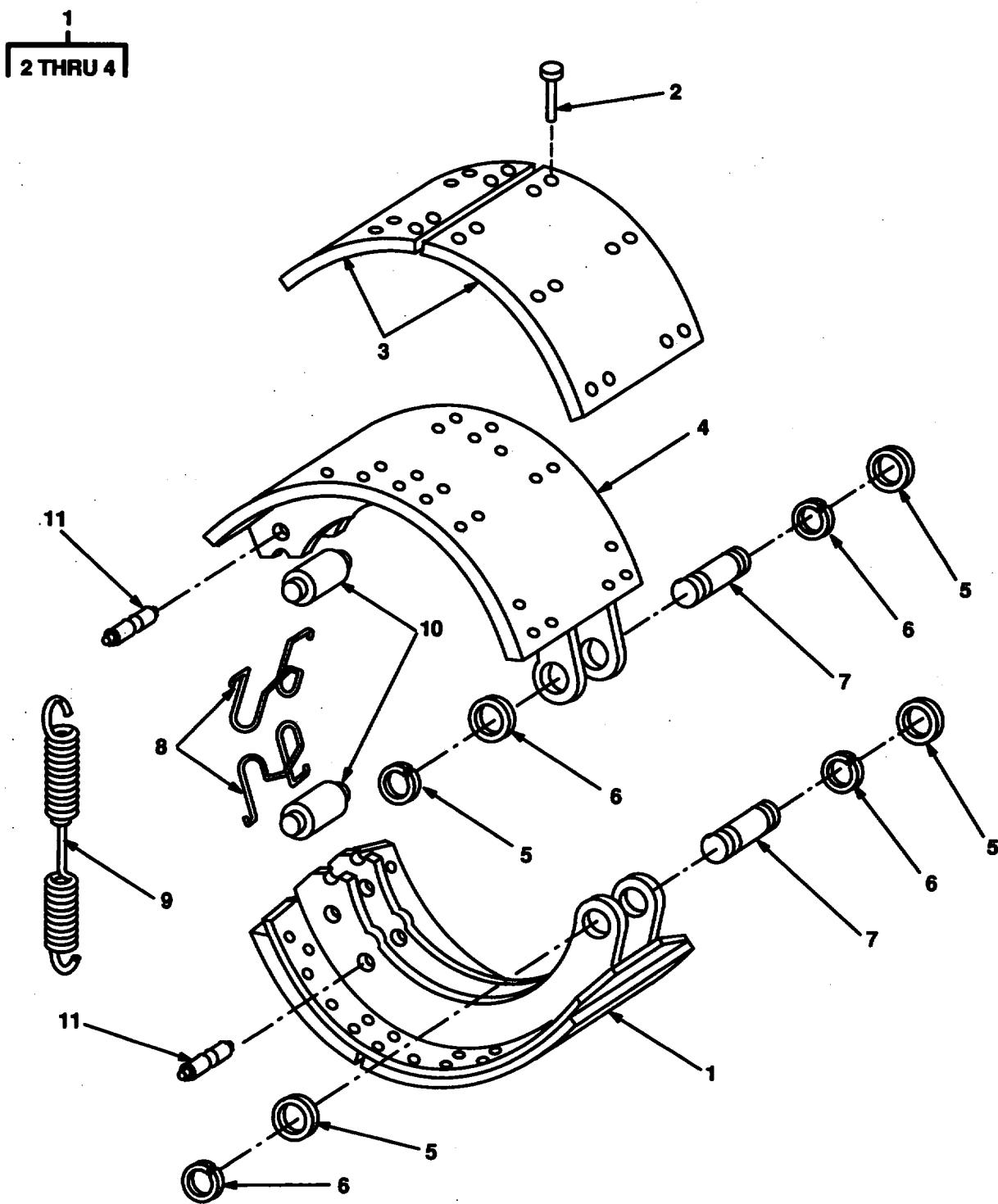
FIGURE 16. BRAKE SHOE ASSEMBLY.
