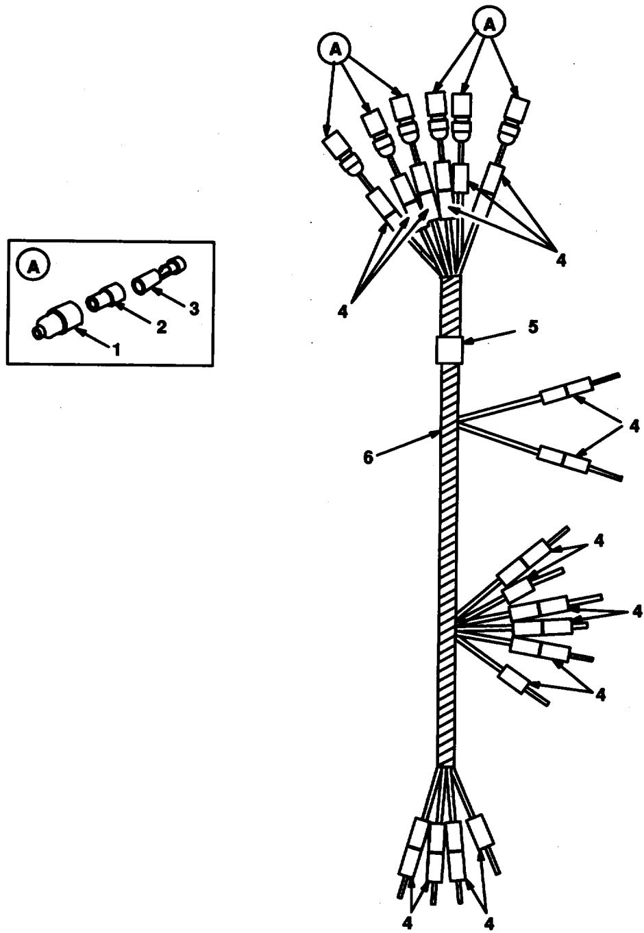
FIGURE 5. TRAILER HARNESS COMPONENTS
