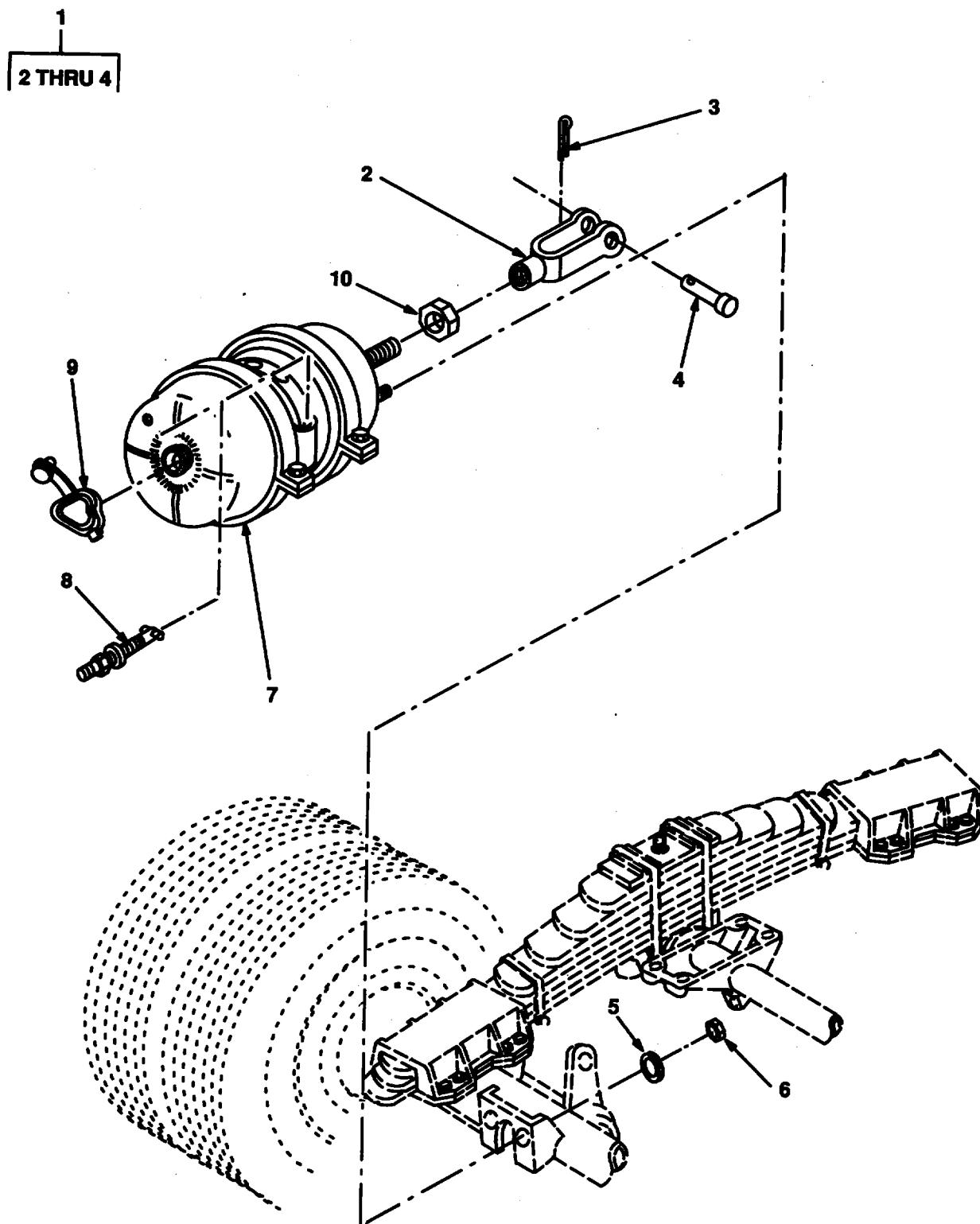
Figure 18. BRAKE AIR CHAMBERS.
