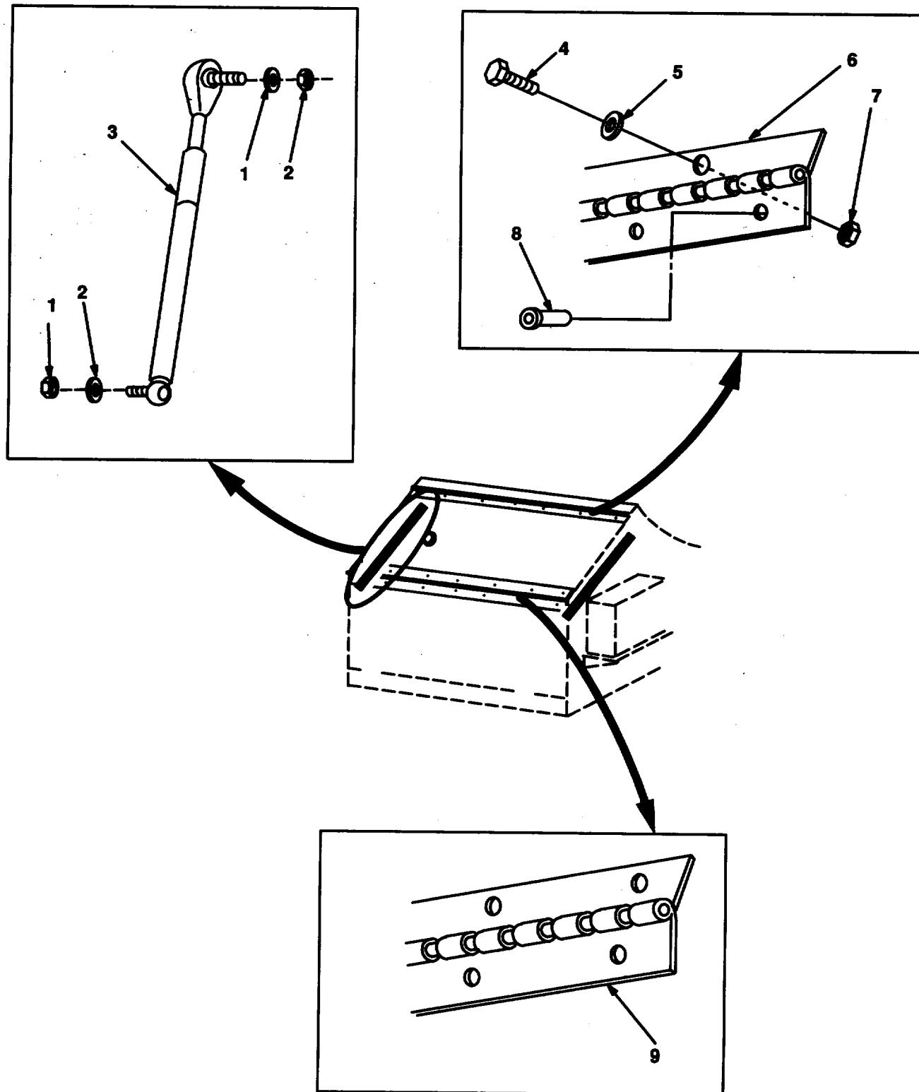
FIGURE 32. ENGINE / PUMP CABINET HARDWARE.
