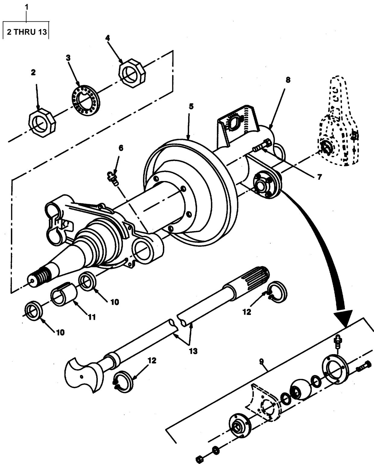
FIGURE 15. REAR AXLE ASEMBLY.
