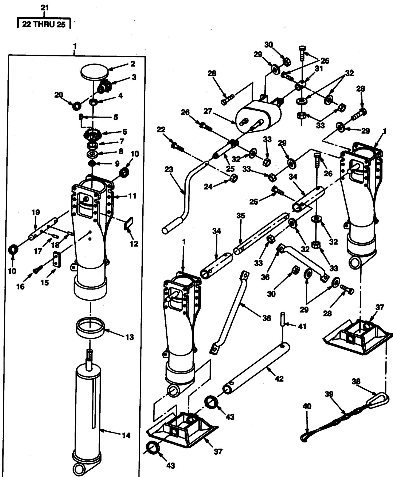
FIGURE 27. LANDING GEAR ASSEMBLY.
