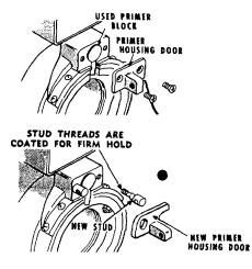
• REMOVE PRIMER HOUSING DOOR. DISCARD DOOR, AND RETAINING SCREWS.
