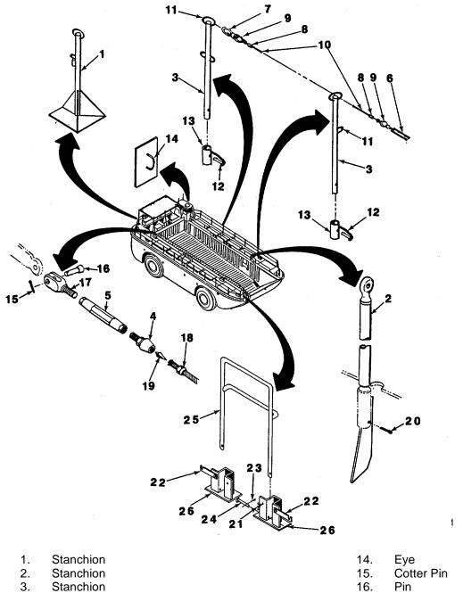
4. Socket 17. Clevis 5. Turnbuckle Sleeve 18. Turnbuckle Plug 6. 19. 7. Snap 20. Cotter Pin Clamp **Butterfly Nut** 8. 21. Thimble Retainer 9. 22. 10. Lifeline 23. Cotter Pin Stanchion Eye Shank Pin 11. 24. 12. Toggle Pin 25. Safety Rail 13. Socket 26. Bracket
