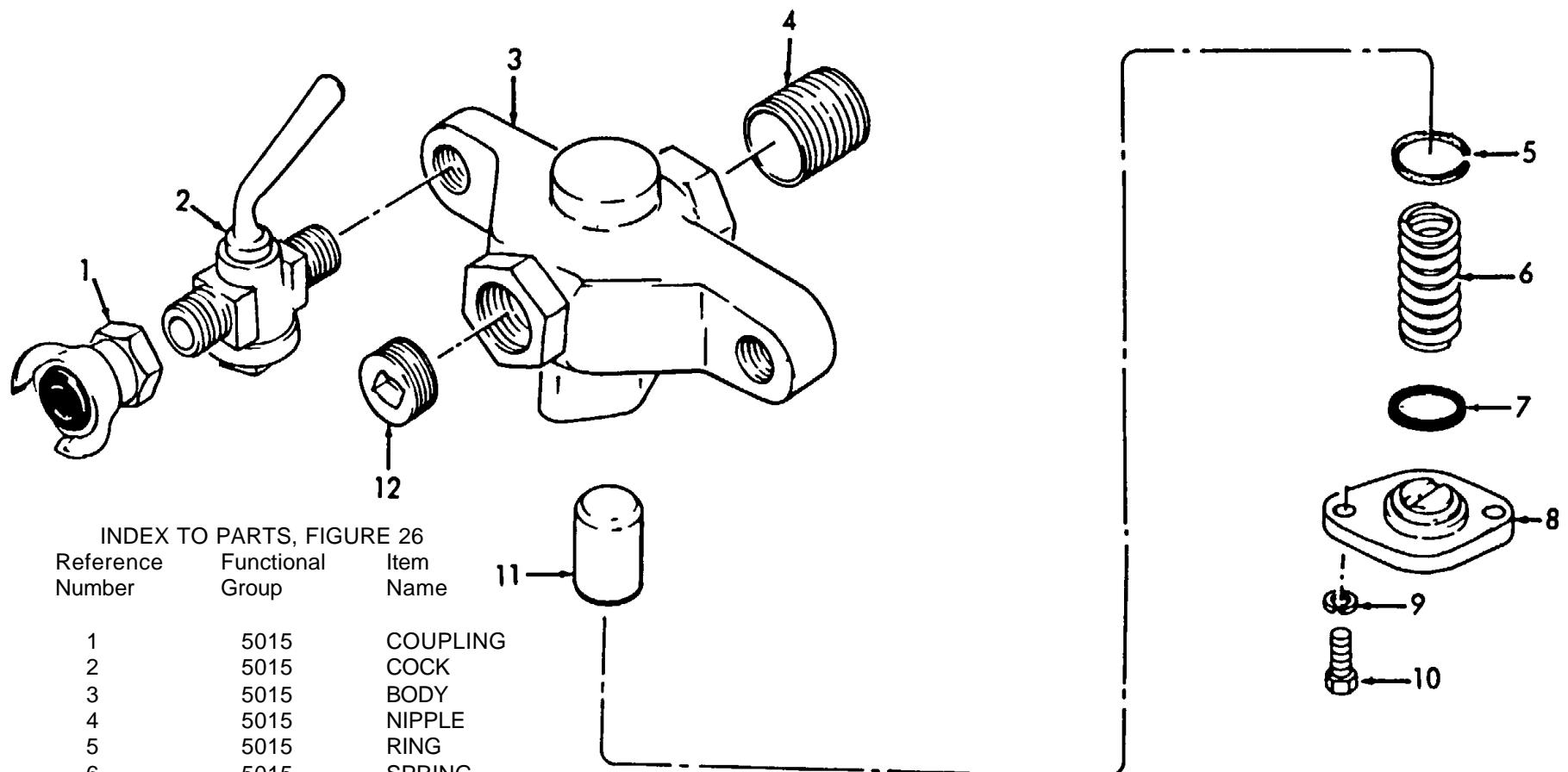
Figure 26. Discharge Valve.
