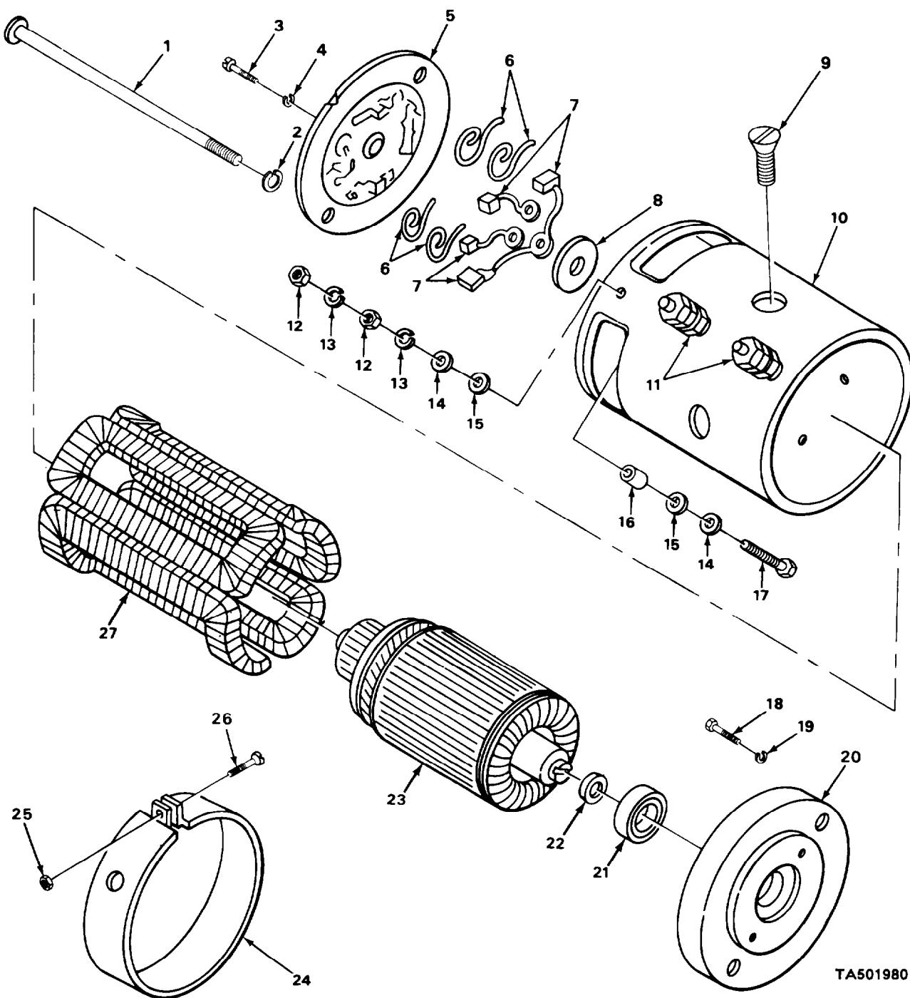
FIGURE 27. ELECTRIC WINCH MOTOR ASSEMBLY.
