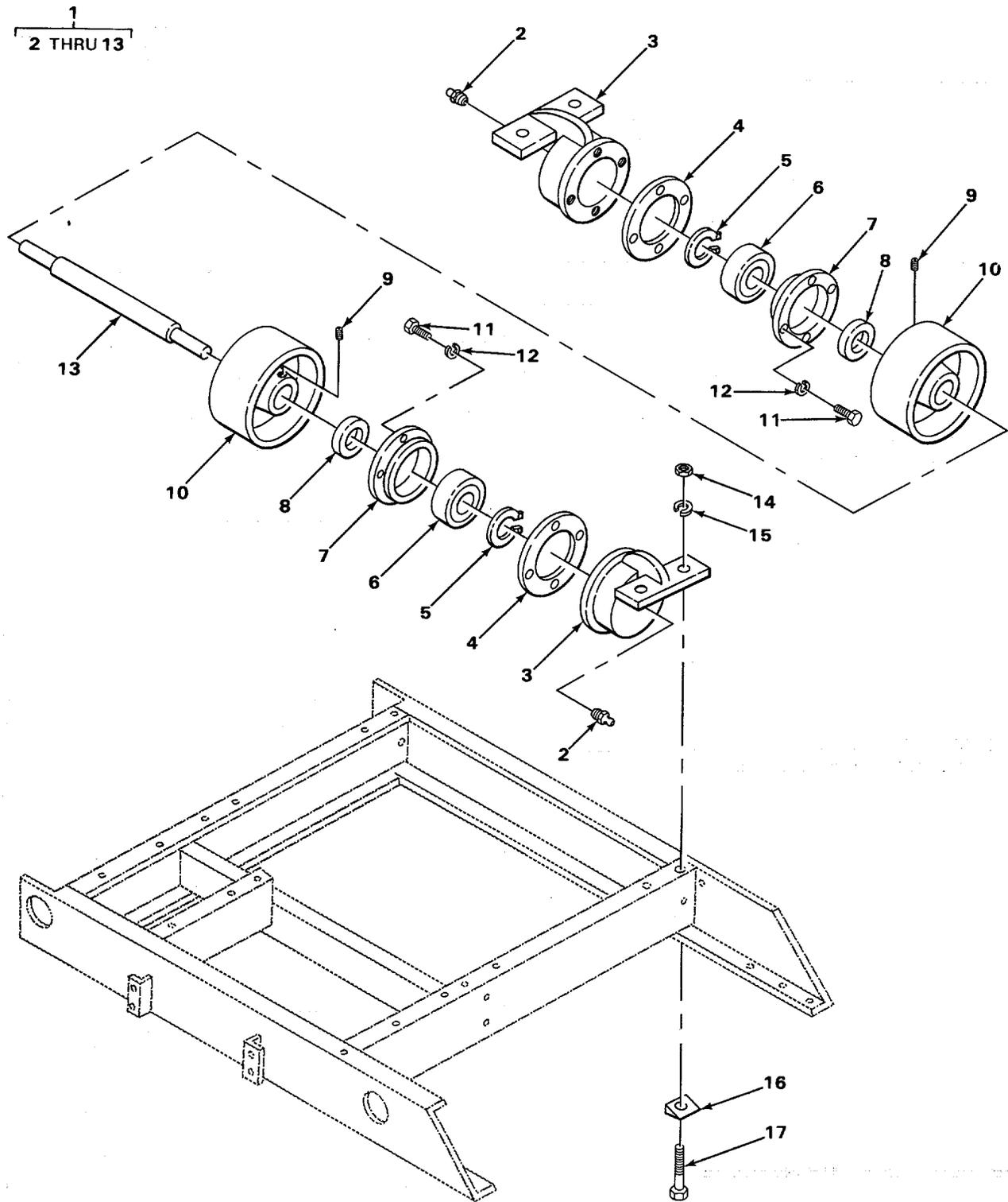
FIGURE 59. DRUM ROLLERS.
