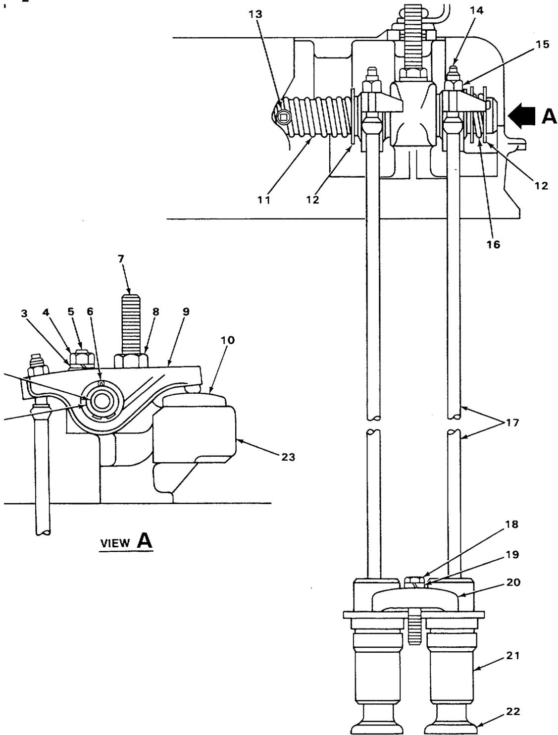
FIGURE 1. ROCKER ARMS, LIFTERS AND PUSH RODS.
