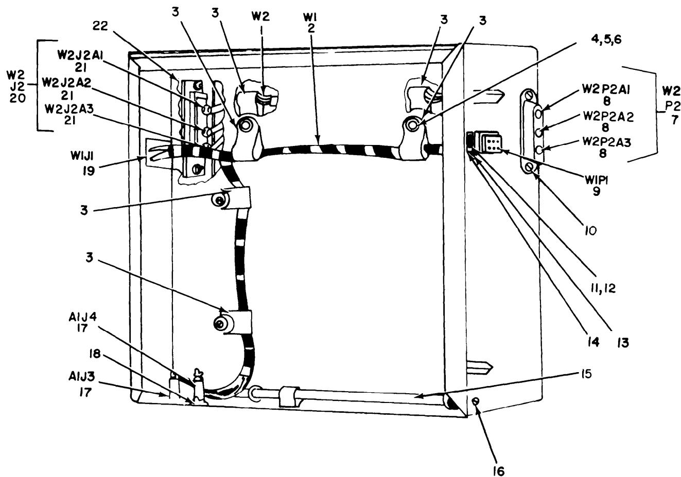
Figure 3. Extender Module MX-4888/URC (1A2).
