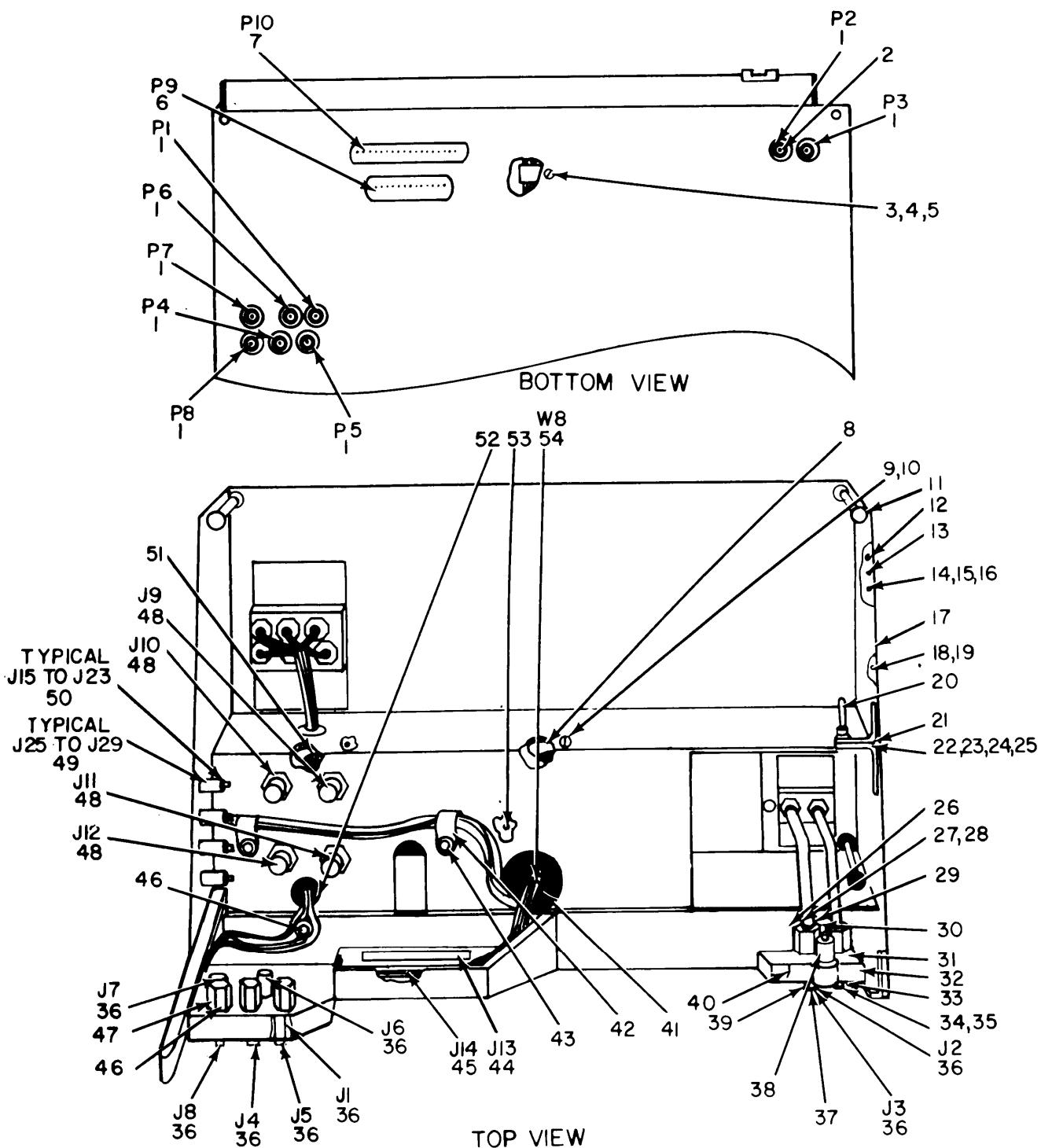
Figure 11. Extender Module MX-4887/URC (1A12).
