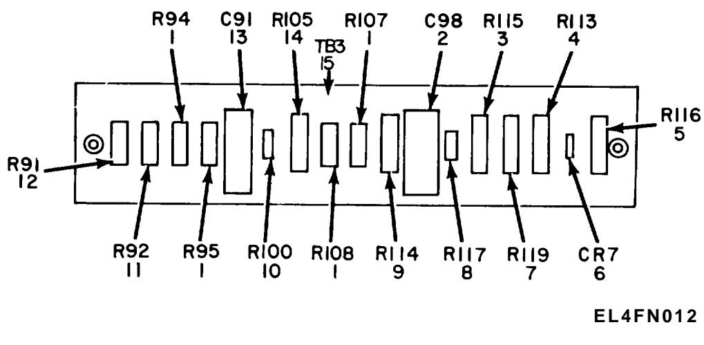
Figure 13. Meter Modulation ME-57/U, Terminal Board Assembly (A5).
