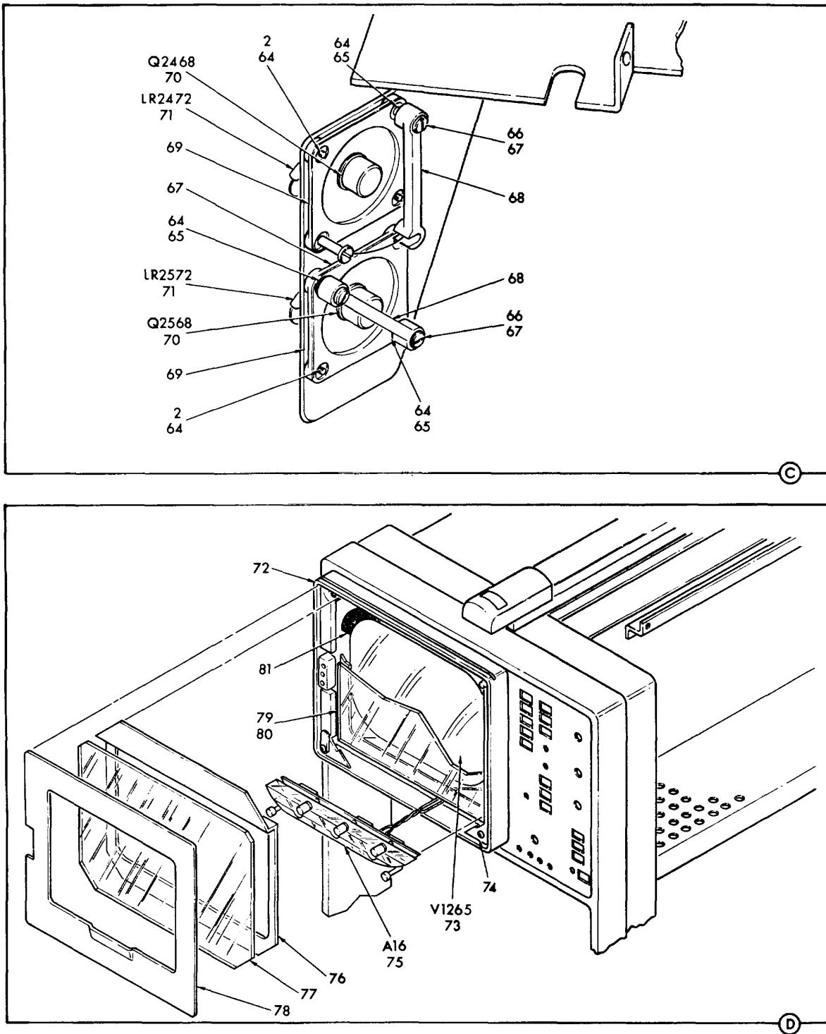
FIGURE 2 -1, OSCILLOSCOPE OS-262/P/U /SWEET 3 OF 6/
