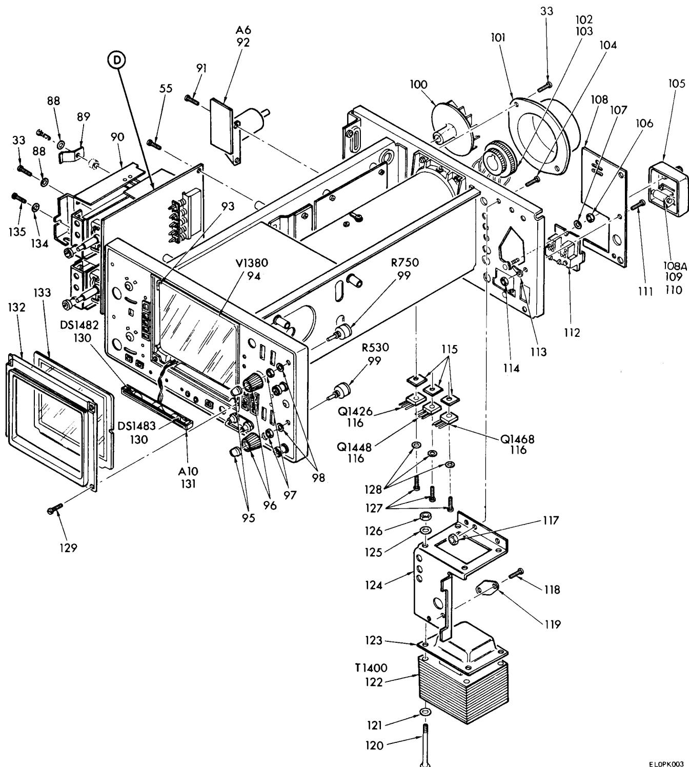
FIGURE 2-1. OSCILLOSCOPE OS-261/U /SHEET 3 OF 6/
