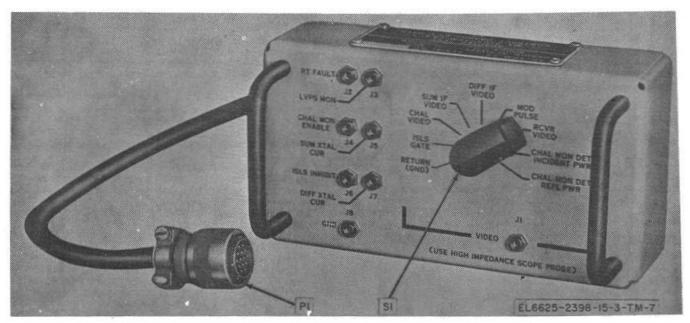
Figure 1-4. Adapter. Test MX-8565/ TPM-24(V).
