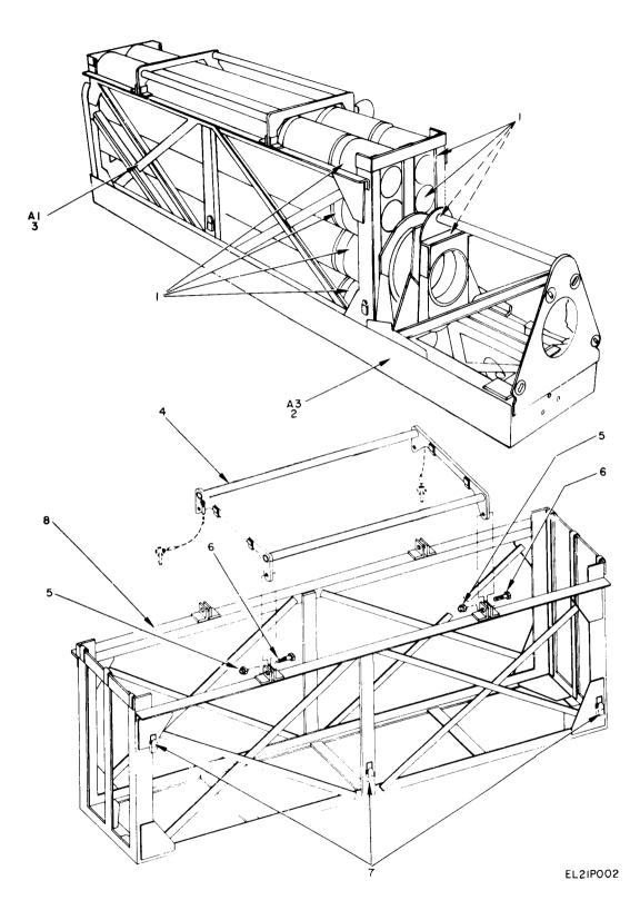
Figure 2. Mast AB-621/G, Carrier.
