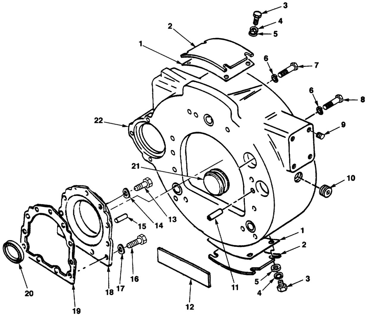
FIG. 6. FLYWHEEL HOUSING ASSEMBLY
