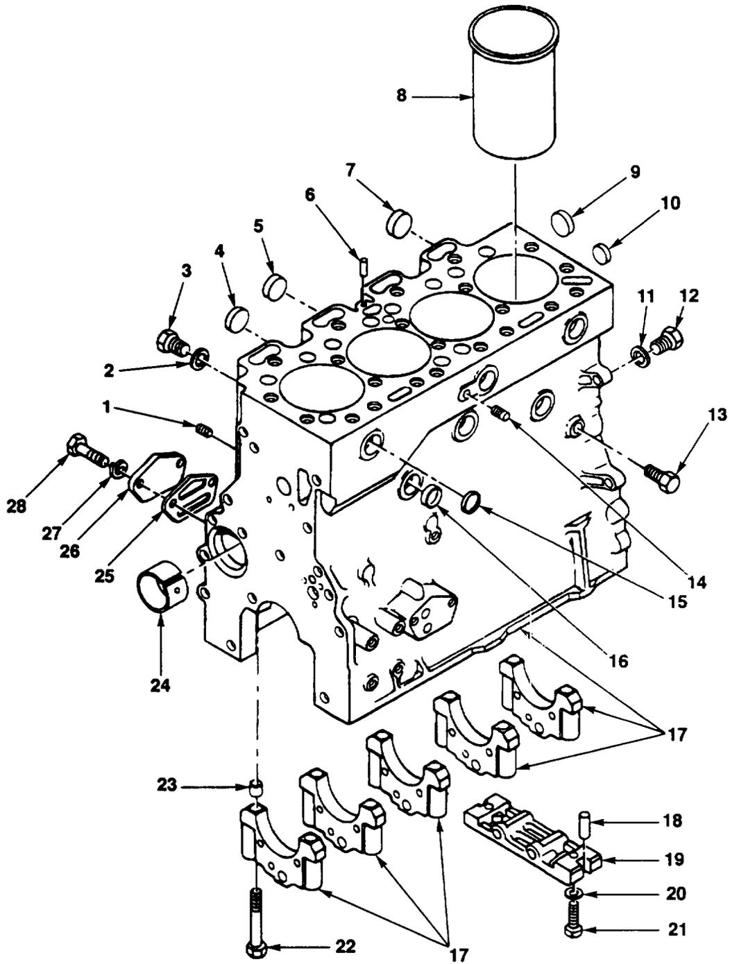
FIG. 2. CYLINDER BLOCK ASSEMBLY
