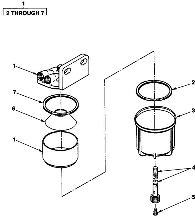
FIG. 29. FUEL/WATER SEPARATOR
