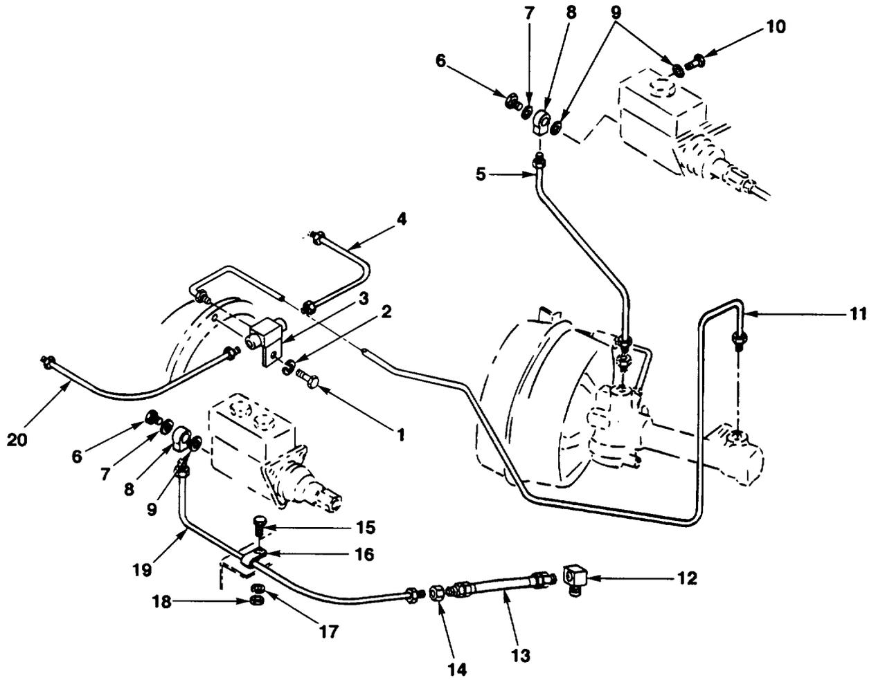
FIG. 81. BRAKE LINES AND FITTINGS
