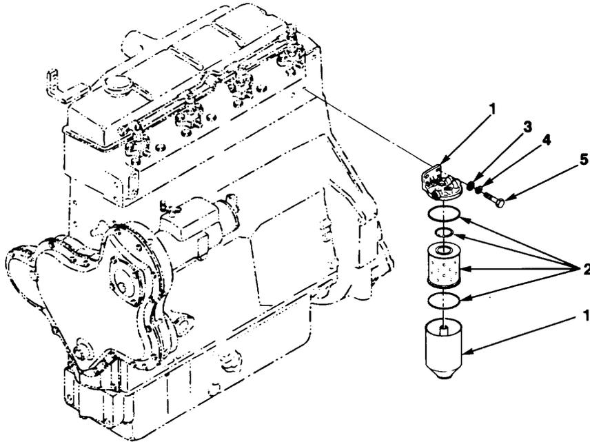
FIG. 28. ENGINE FUEL FILTER
