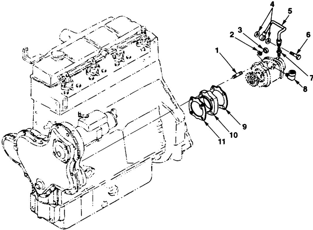
FIG. 83. ROTARY VACUUM PUMP INSTALLATION
