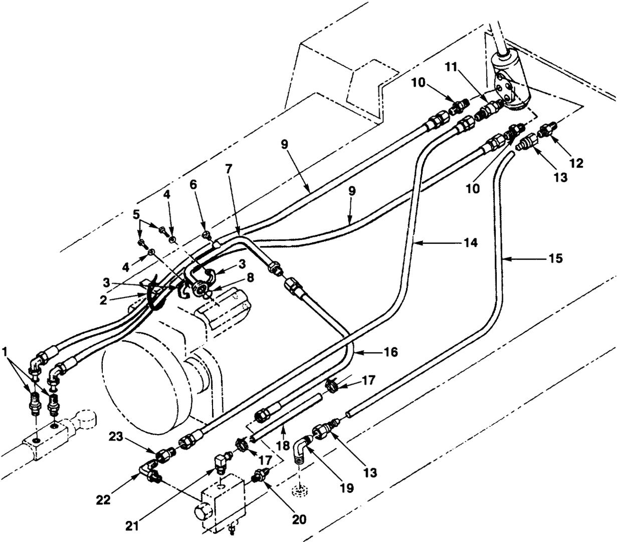
FIG. 97. STEERING LINES AND FITTINGS
