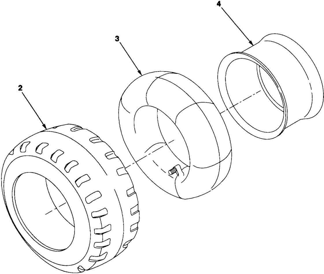
FIG. 92. REAR STEERING AXLE TIRE/TUBE
