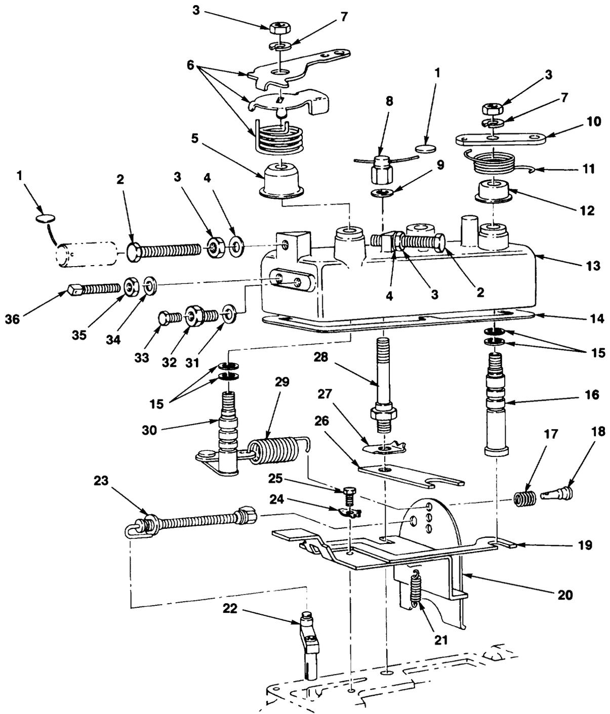
FIG. 22. FUEL INJECTION PUMP GOVERNOR CONTROL ASSEMBLY
