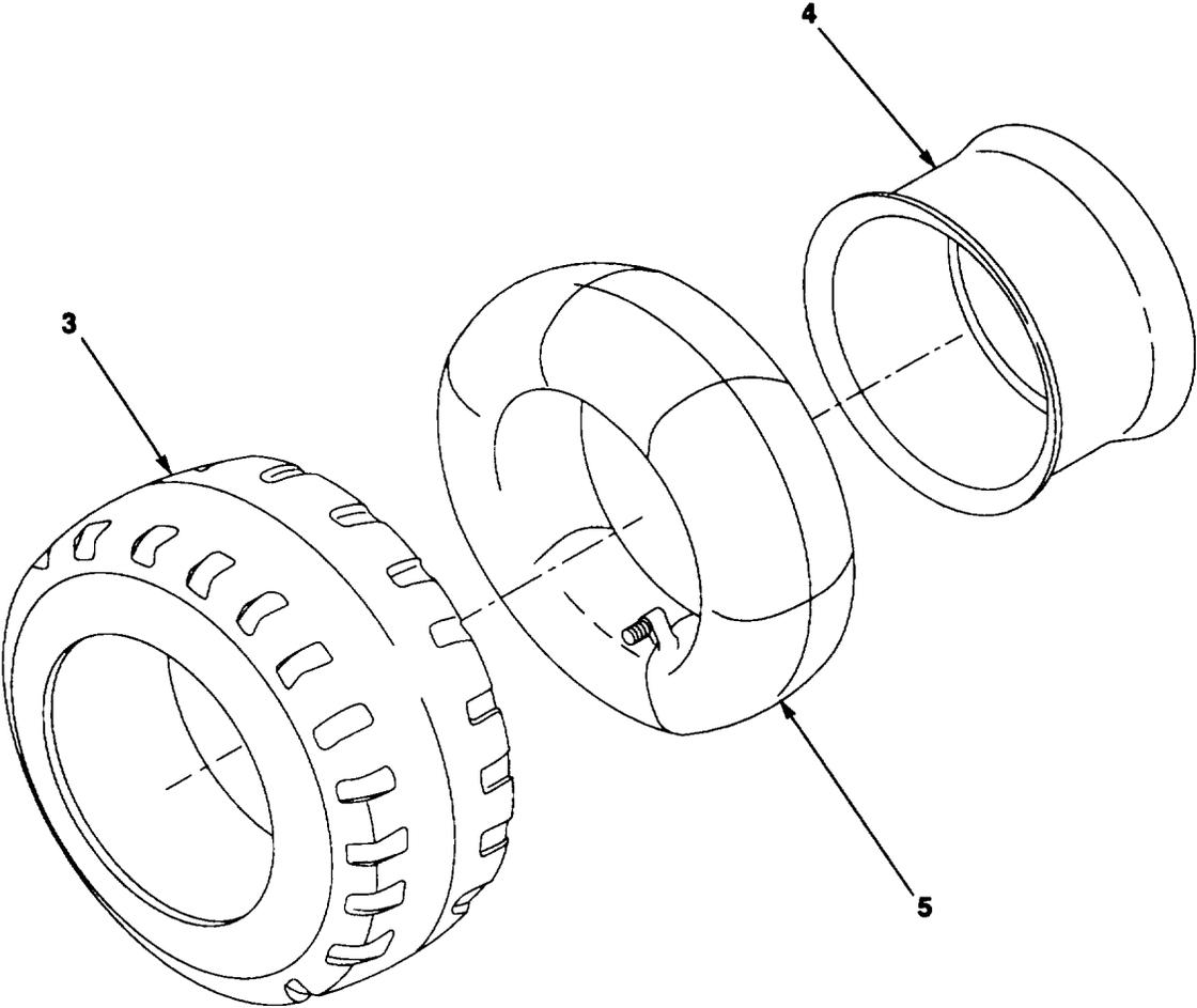
FIG. 91. FRONT DRIVE AXLE TIRE/TUBE
