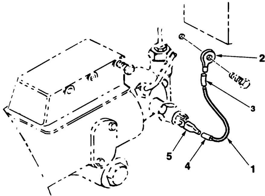
FIG. 54. ENGINE SHUTOFF SOLENOID WIRING
