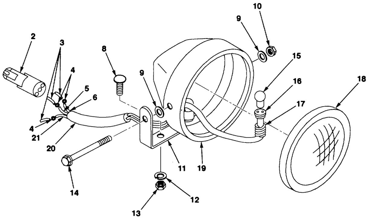
FIG. 47. STOPLIGHT/TAILLIGHT ASSEMBLY
