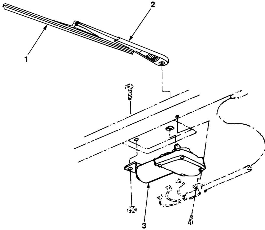
FIG. 112. SKYLIGHT WINDOW WIPER ASSEMBLY
