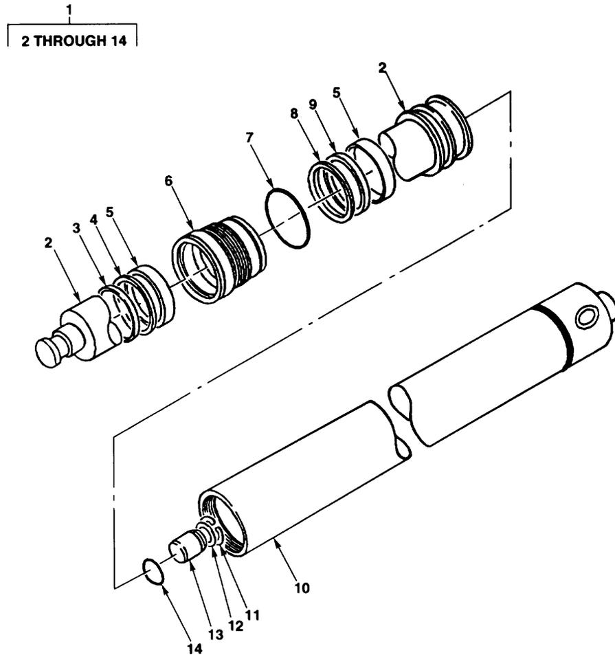
FIG. 137. THREE STAGE UPRIGHT FREE LIFT CYLINDER ASSEMBLY
