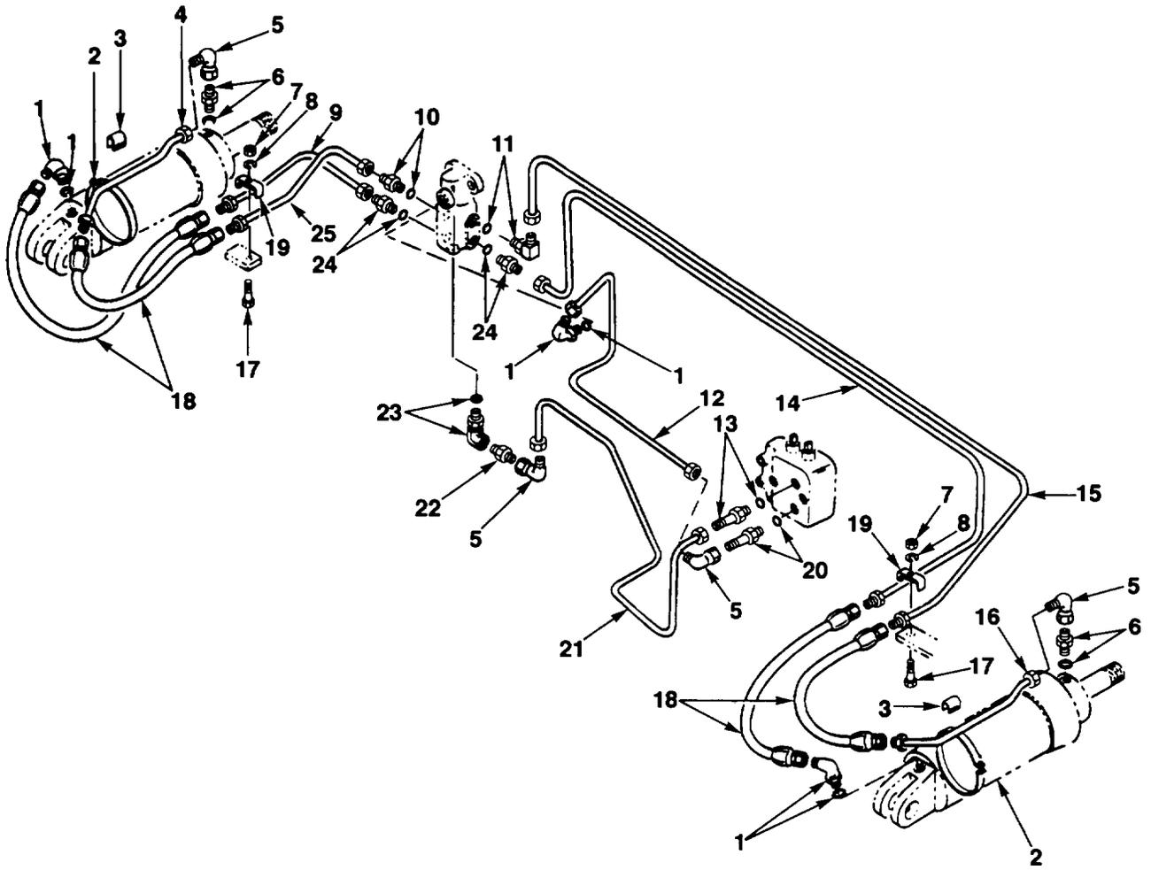
FIG. 140. TILT CYLINDER LINES AND FITTINGS
