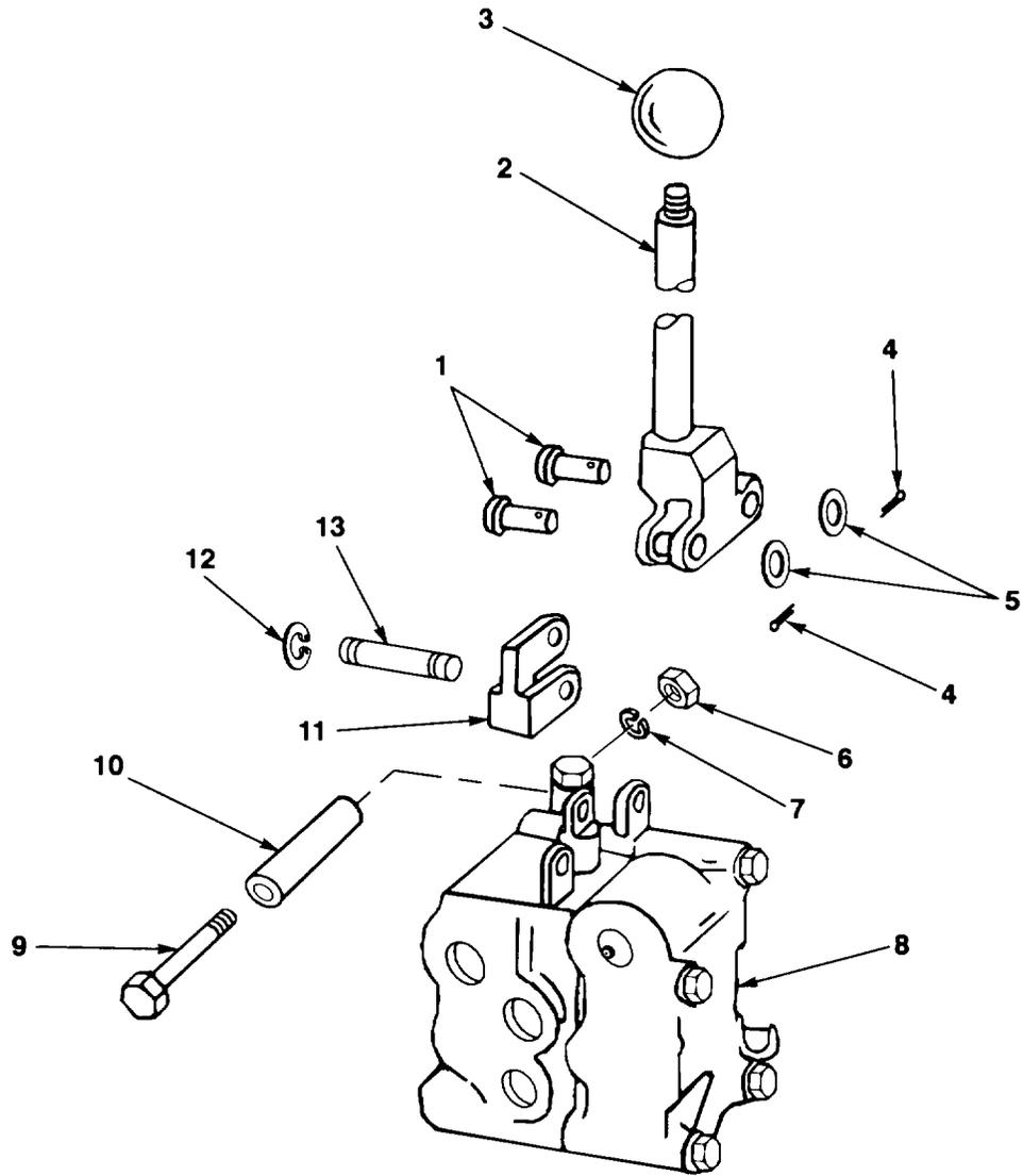
FIG. 129. AUXILIARY CONTROL VALVE LEVERS
