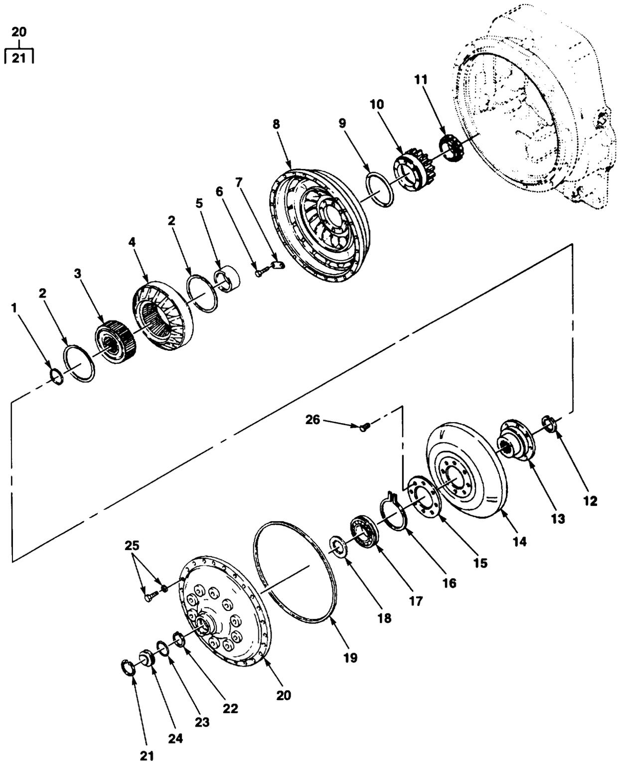
FIG. 59. TORQUE CONVERTER
