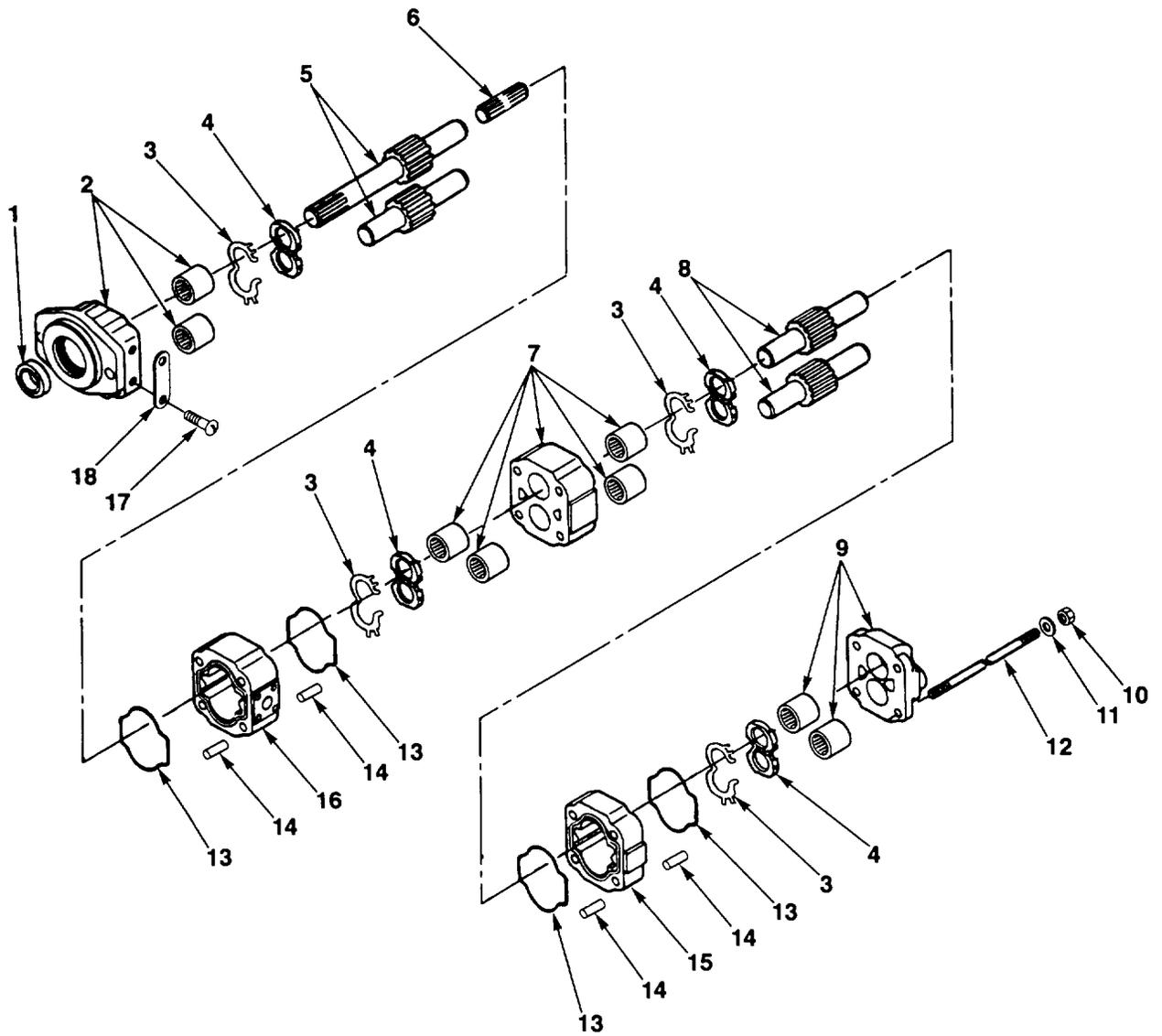
FIG. 118. HYDRAULIC PUMP ASSEMBLY
