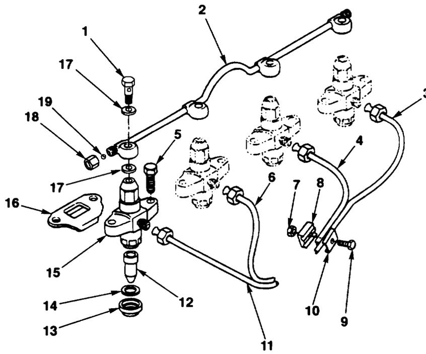
FIG. 17. FIJEL INJECTOR, LINES AND FITTINGS
