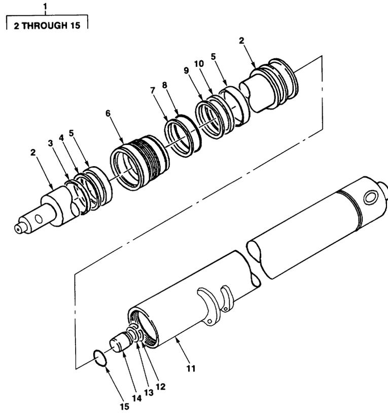
FIG. 138. THREE STAGE UPRIGHT LIFT CYLINDER ASSEMBLY
