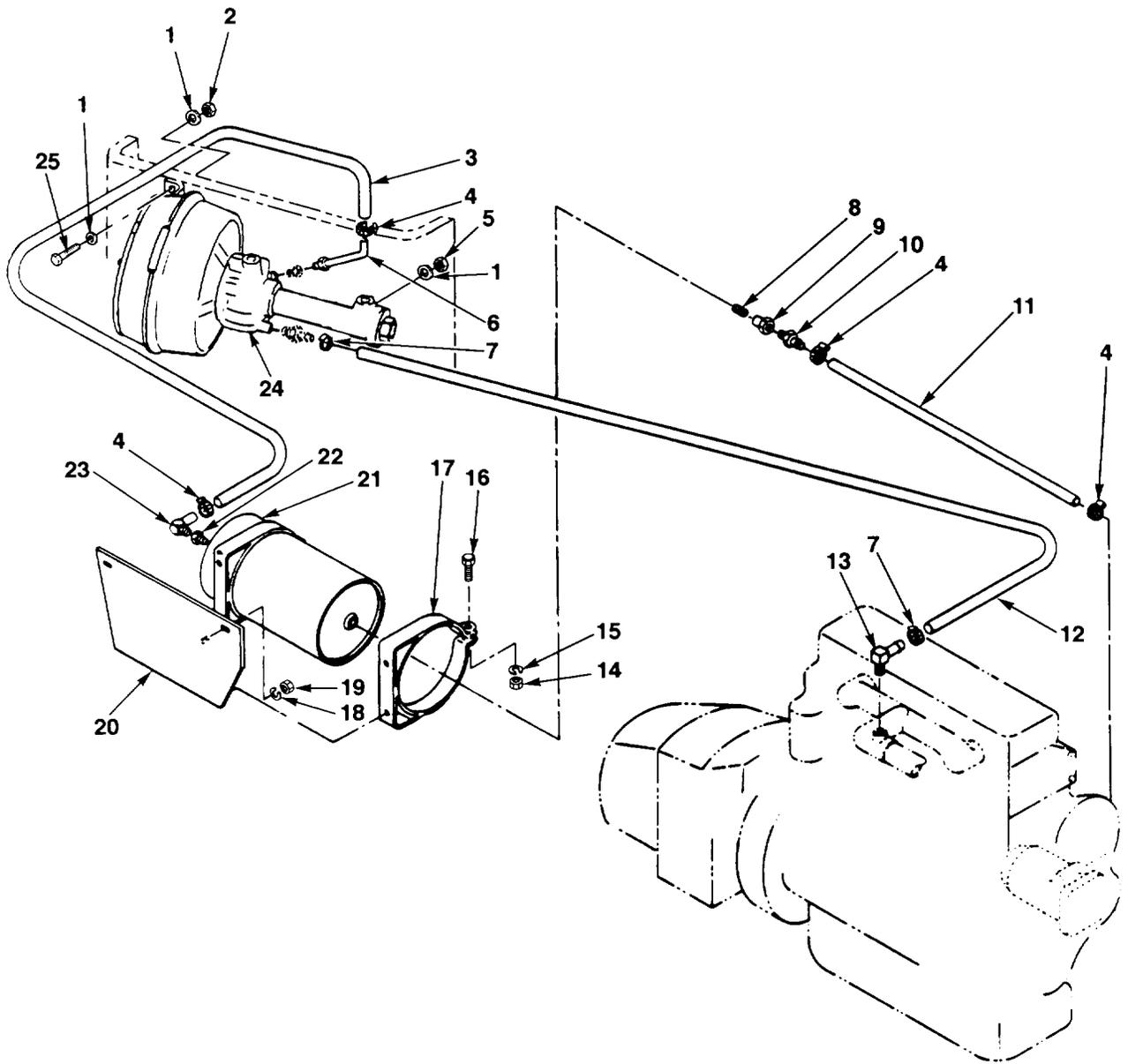
FIG. 85. VACUUM PUMP LINES AND FITTINGS
