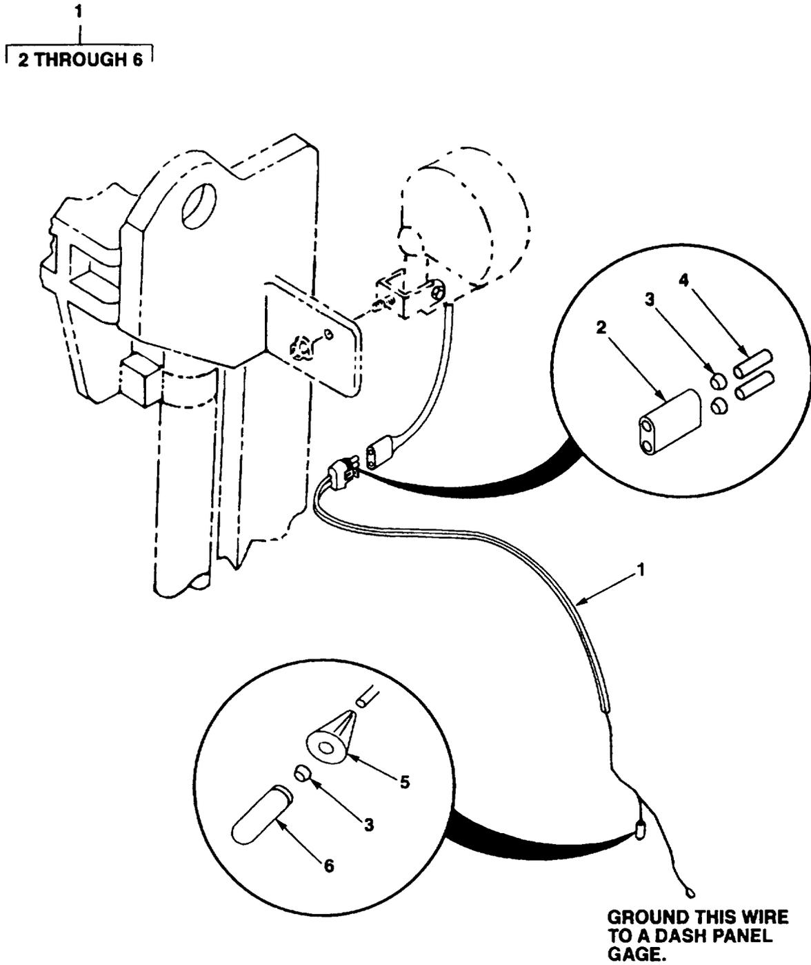
FIG. 51. FRONT FLOODLIGHTS WIRING
