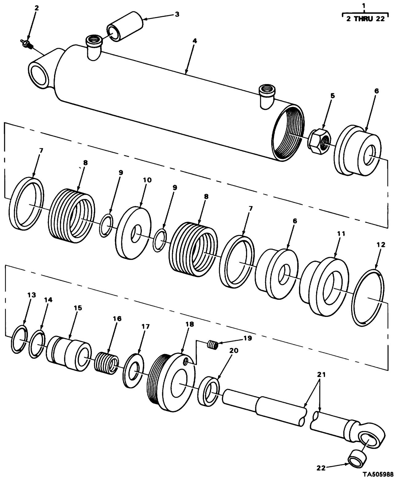
FIGURE 128. SLAVE CYLINDER (MODEL RTL10) .
