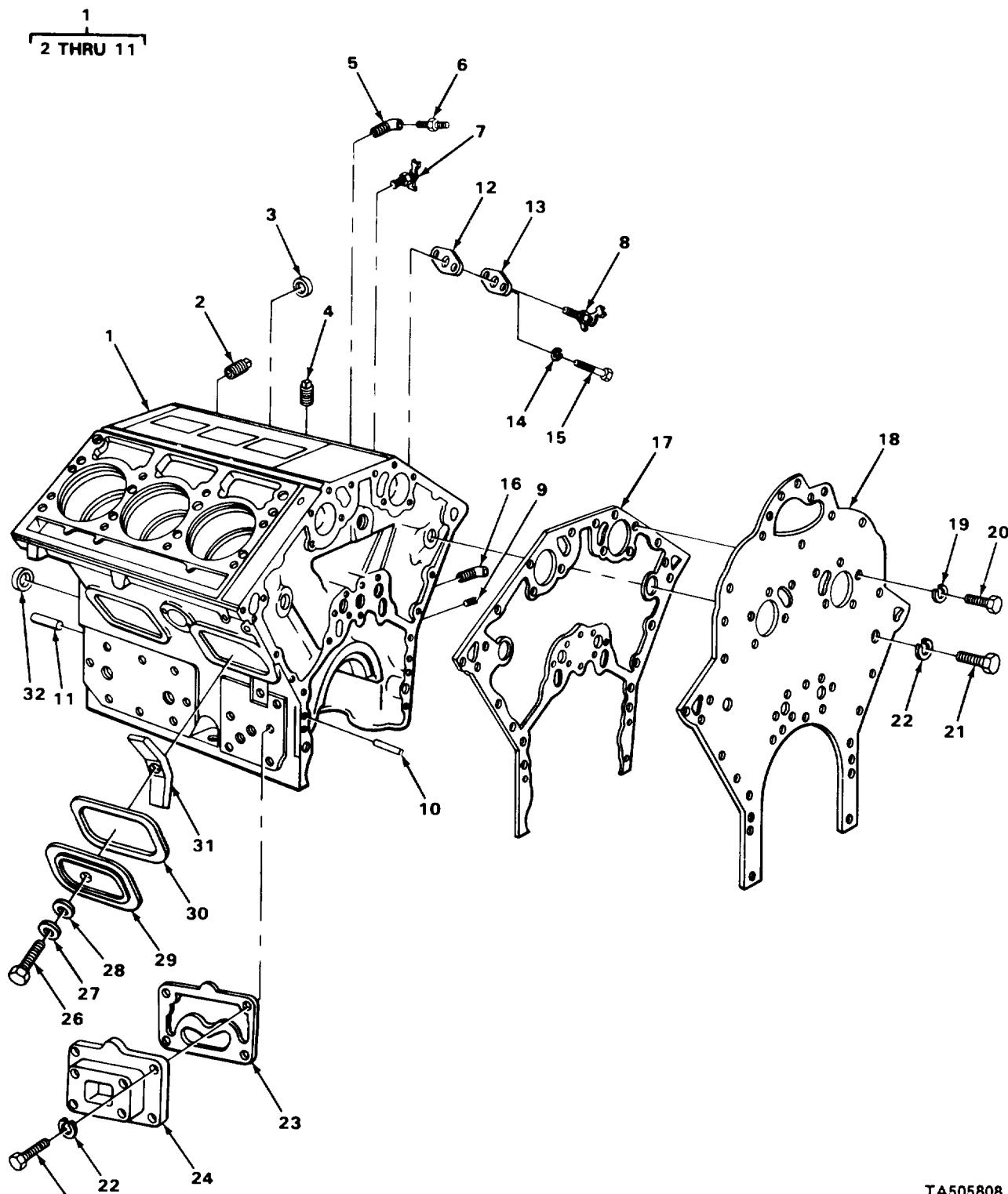
FIGURE 1. CYLINDER BLOCK.
