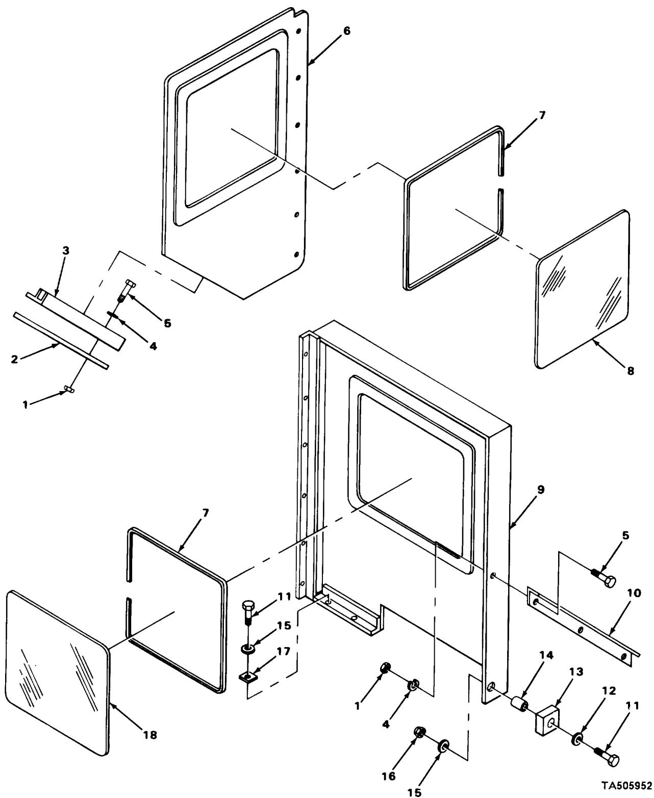
FIGURE 99. OPERATORS SHIELD.
