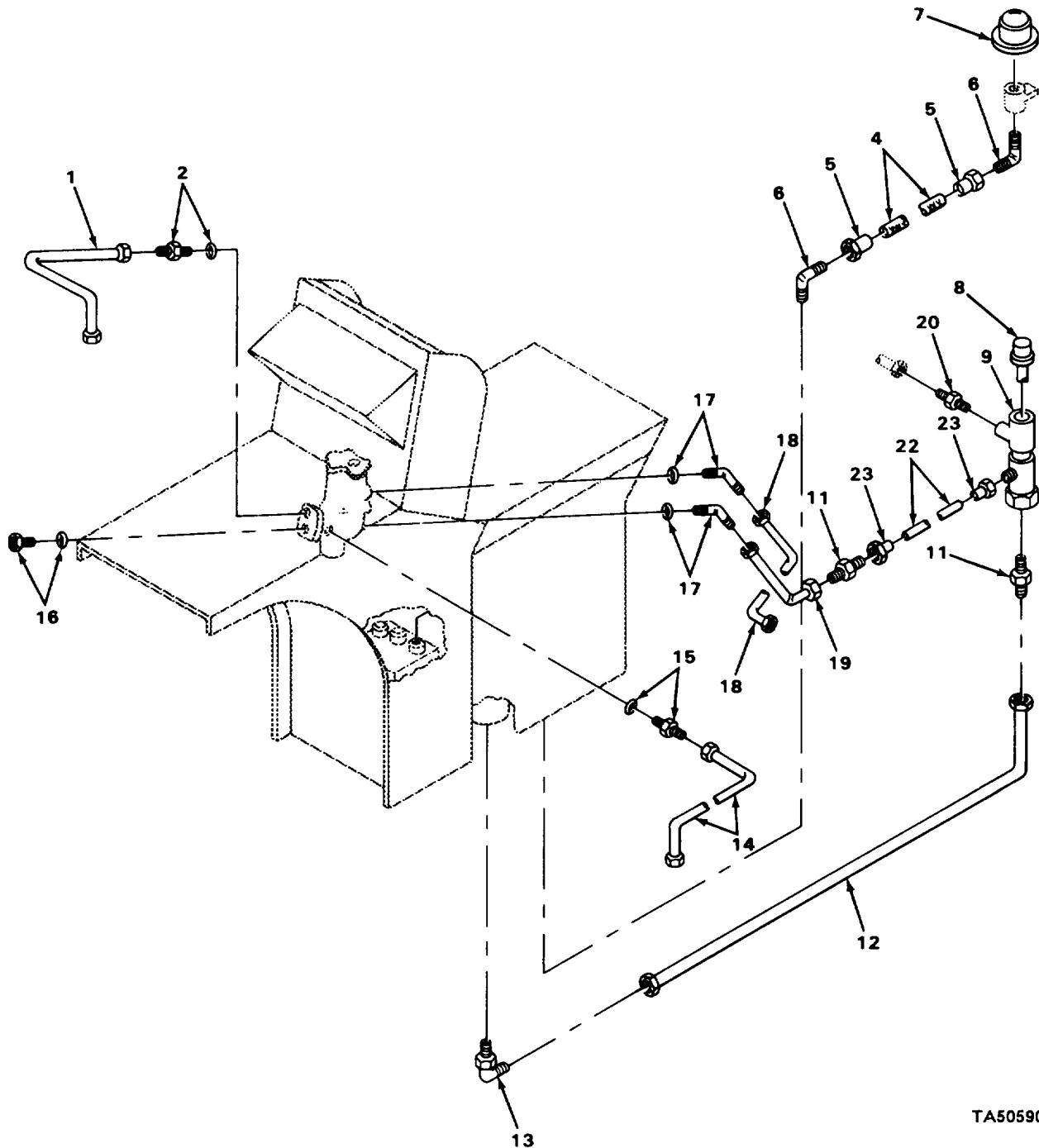
FIGURE 63. BRAKE VALVE PIPING (MODEL RTL 10).
