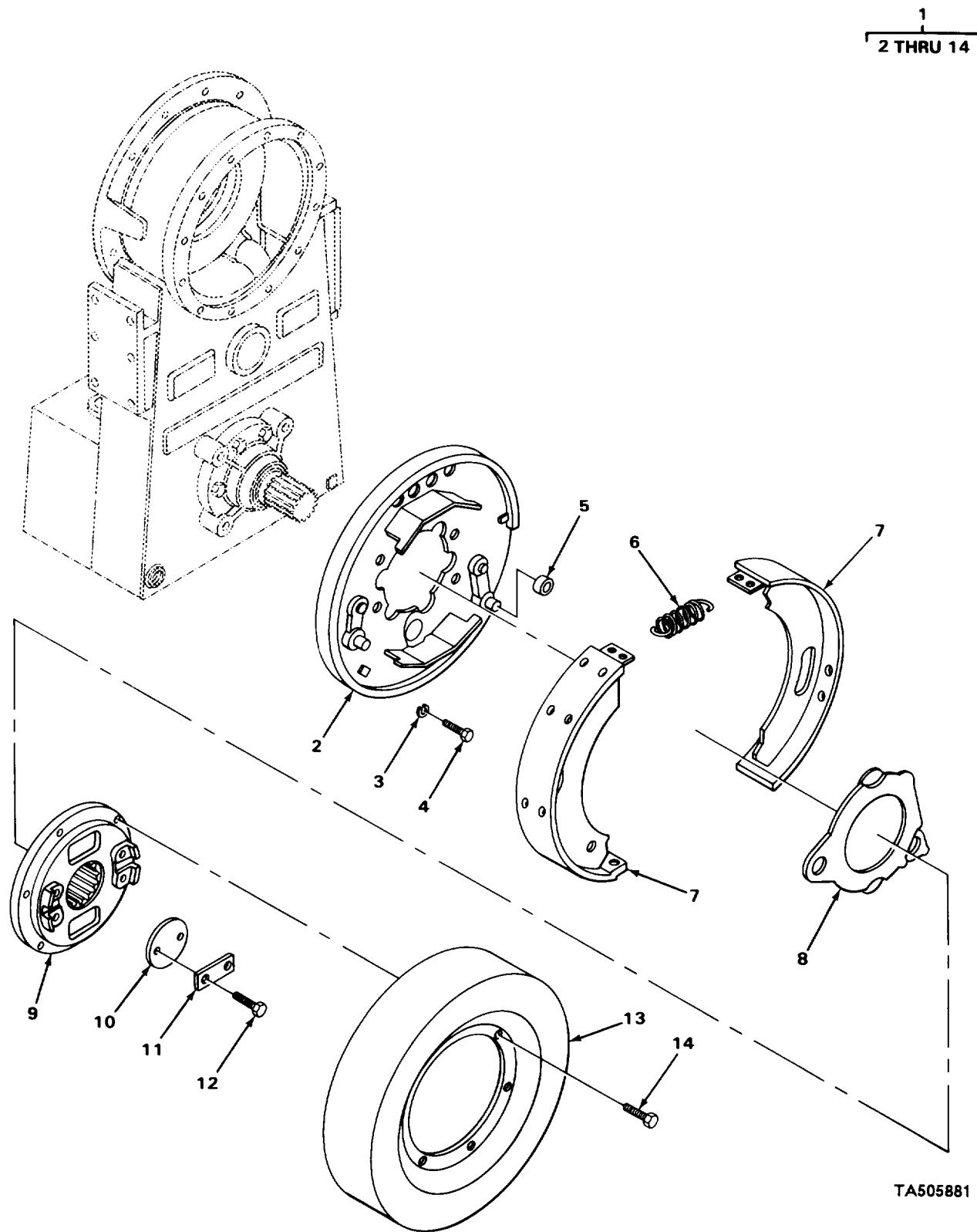
FIGURE 48. TRANSMISSION HANDBRAKE.
