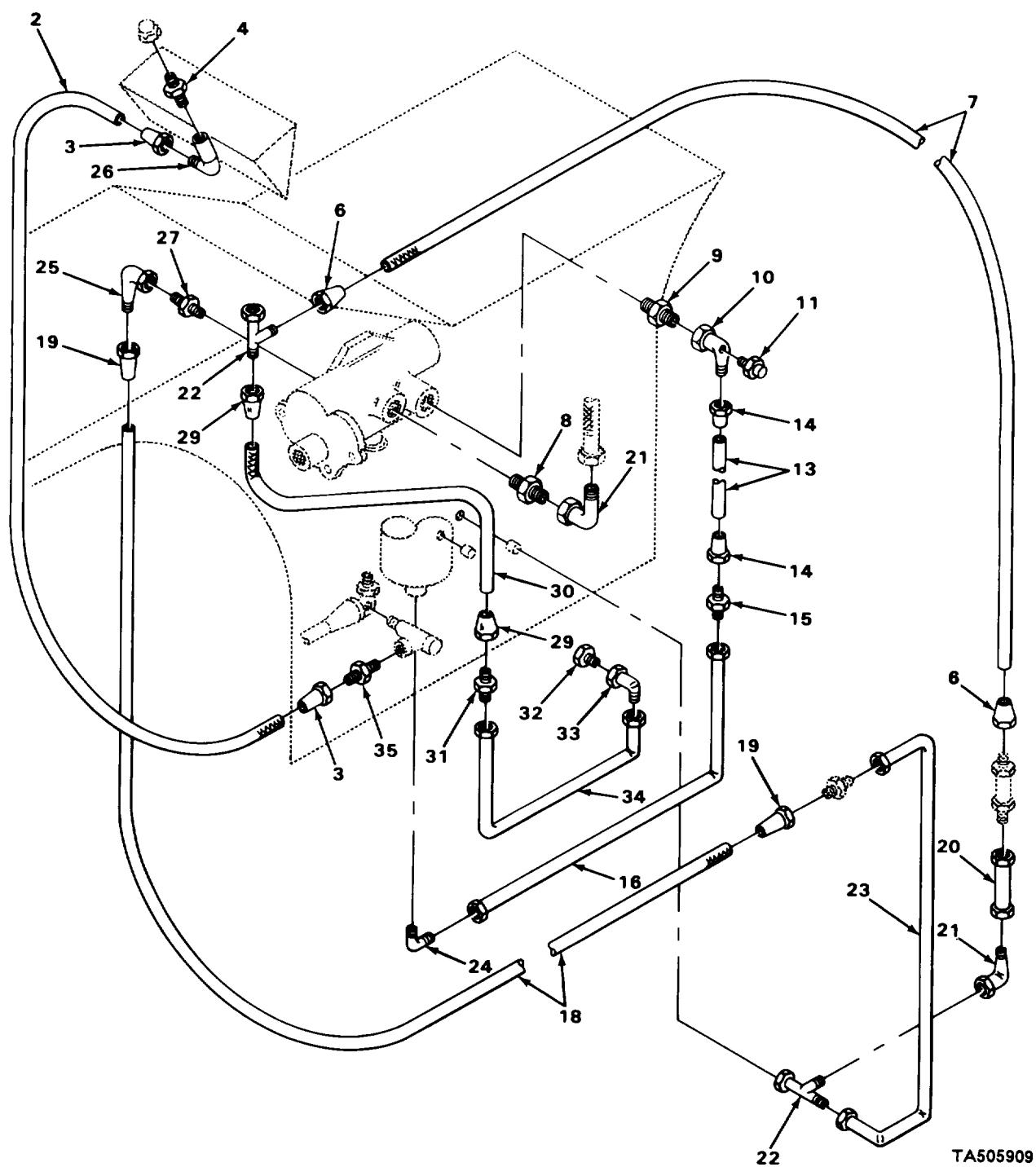
FIGURE 64. BRAKE VALVE PIPING (MODEL RTL 10-1).
