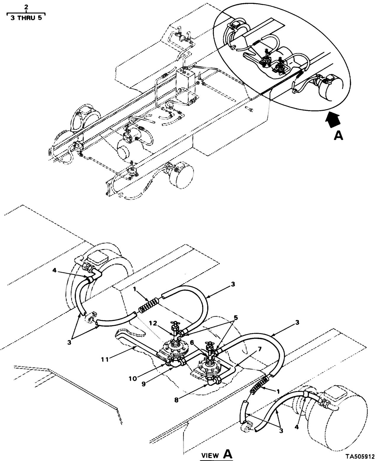
FIGURE 67. BRAKE LINES AND FITTINGS, REAR.
