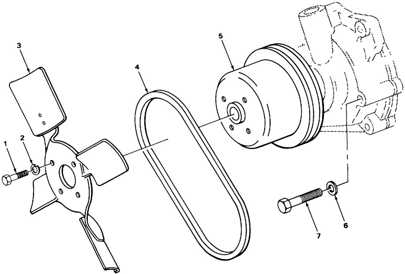
FIGURE 28. FAN ASSEMBLY.
